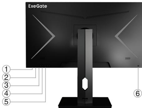
1.(AUTO): Автонастройка / выход из меню; 2.(Menu): Меню; 3.(Up): Вверх; 4.(Down): Вниз; 5.(Power): Вкл./Выкл.; 6.(🔒): K-Slot - защитный замок
